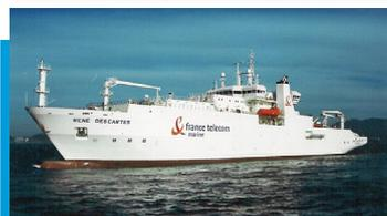
Pour transporter l'énergie produite en mer il faut poser un câble entre les hydroliennes ou éoliennes posées. Ce sont des navires câblés comme celui de France Telecom Marine qui sont utilisés. Il faudra construire de nouveaux bateaux et des barges pour transporter les machines et faire la maintenance. STX à Saint Nazaire étudie le projet.
